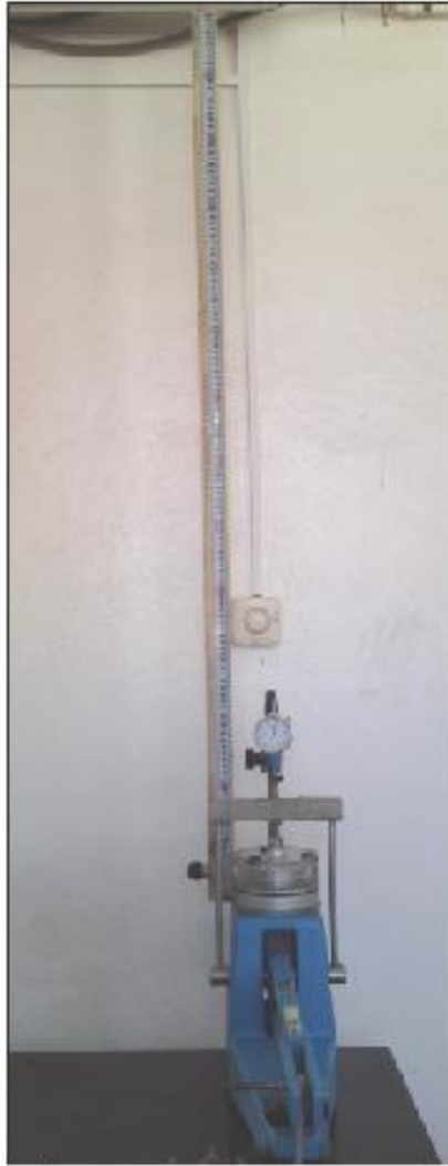
الشكل (1-2) جهاز الآدومتر في مخبر الخدمات الفنية بحمص مع أنبوب بيزومتري موصول إلى خلية التشديد .
